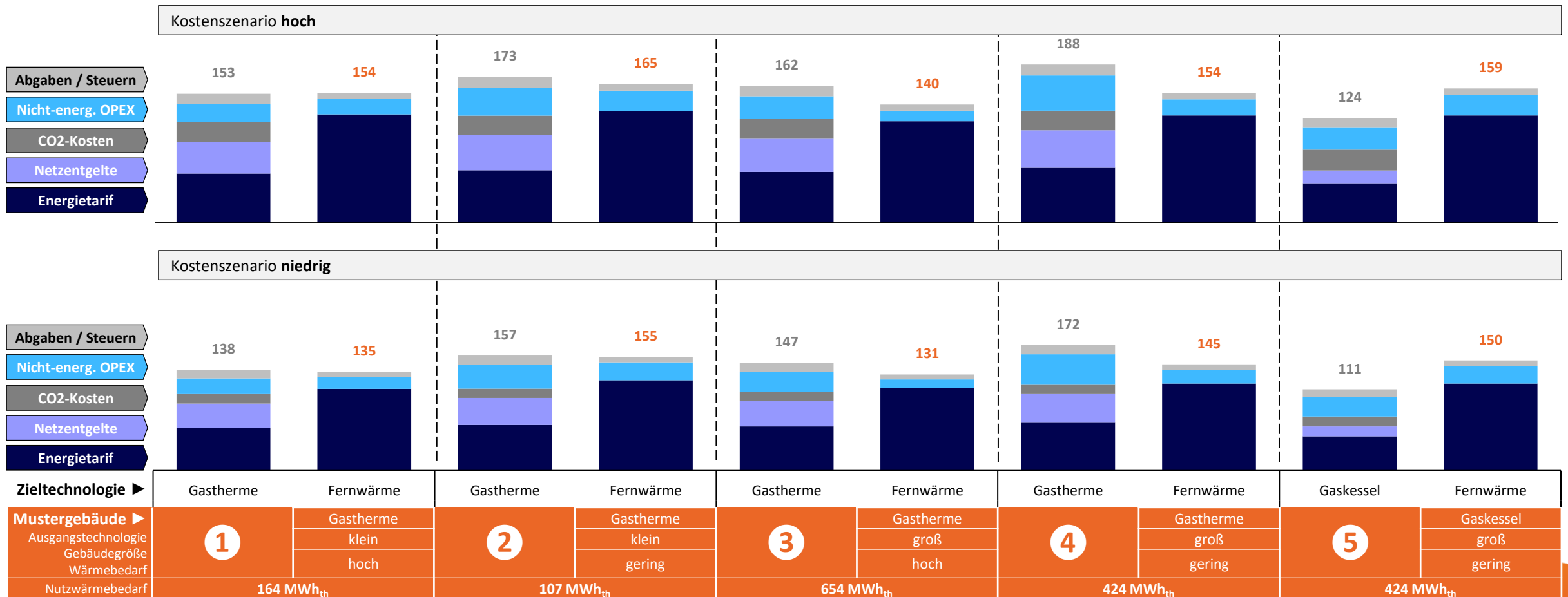
Betriebskosten [1] EndverbraucherInnen im ersten Jahr (2026) als EUR je MWh nutzbare Wärme [EUR / MWh th ]
