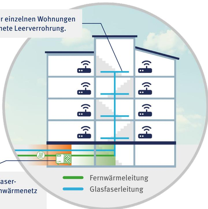
Wir errichten den Glasfaseranschluss über das Fernwärmenetz bis in den Keller.
